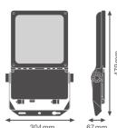
**Scheda tecnica Ledvance Proiettore LED Flex Bianca 80W 8400lm 55x120D - 822 Bianco Molto Caldo | IP66 - Asimmetrico**
